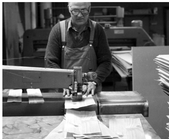
En af arbejdsprocesserne er at skære finér, og det kræver præcisionsarbejde. 1977.
