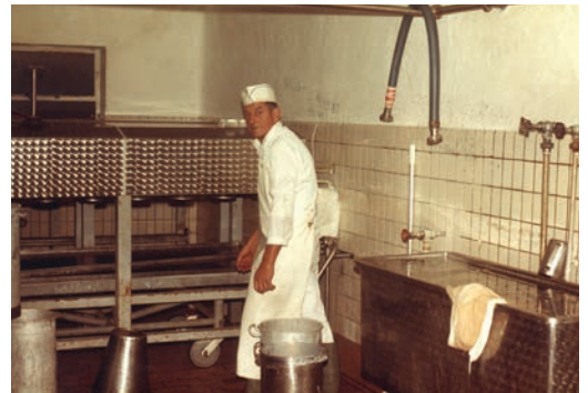
Pressen, hvor ostene stod i pres i ca. 45 min. Henry Jespersen er med på billedet.
