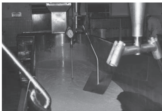
Fyldningen af karret er lige begyndt med tapperøret til venstre. Her brugtes røreplader, indtil løben var tilsat.
