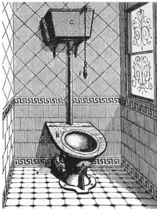
Vandskylende toilet med højsiddende cisterne. Engelsk udgave fra århundredskiftet.
