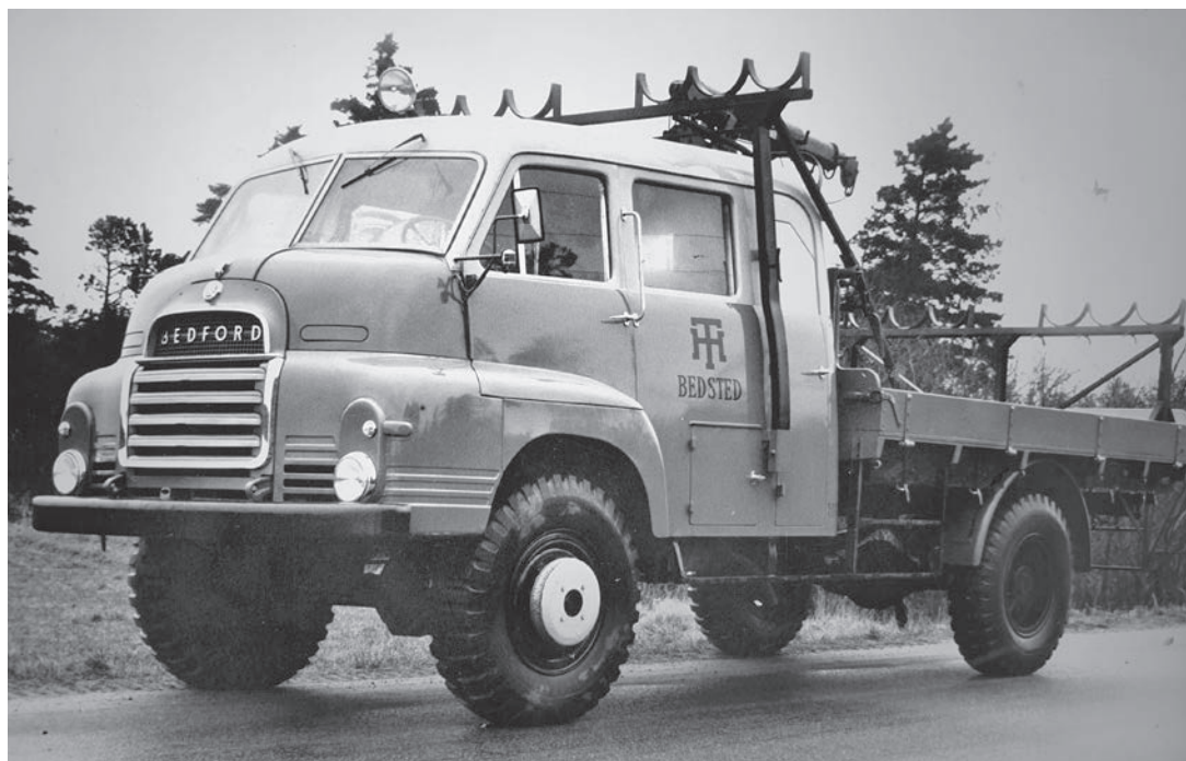
Denne vogn var den første, der blev monteret med hydraulisk boregrej og løftekran.
