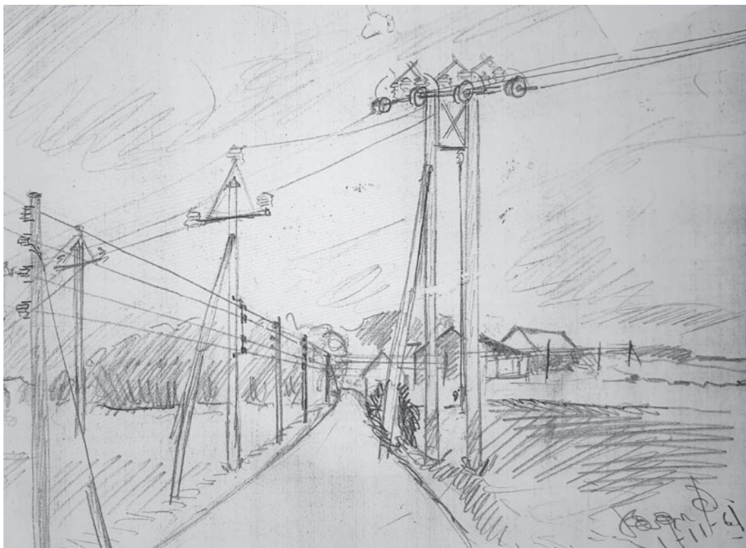
Den høje mastekonstruktion bærer strækningsafbryder nr. 1 Øland, med gården "Øland" i baggrunden. Frihåndstegningen er tegnet af kabelmesterassistent, Vagn Østergaard, Snedsted, i middagspausen d. 1-11-1961. Han blev senere afholdt lærer på Hadsten Håndværkerskole, hvor han underviste elektrikerlærlinge.
