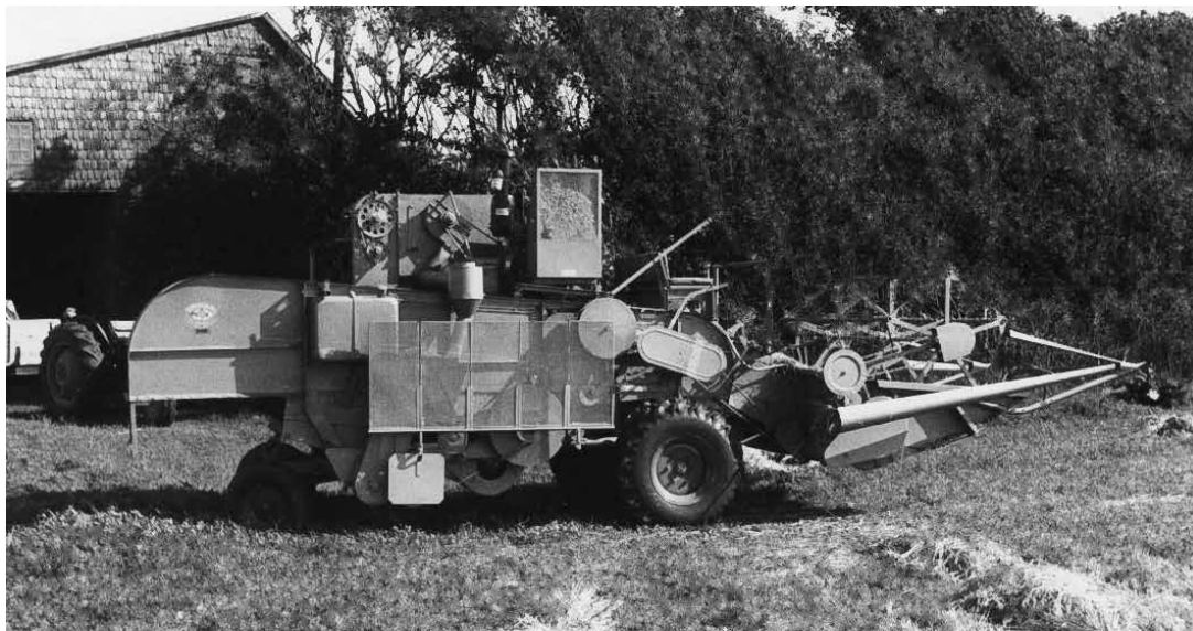
En mejetærsker benyttet på Vester Ulsted. De første mejetærskere brugte en halmryster for at skille kornet fra strået, og kornet blev herefter samlet i sække, mens halmen blev strøet ud af maskinen, mens den kørte.
