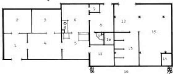
Fig. 3. Grundplan af beboelse, stald og lade, tegnet efter oplysninger af Peder Christian Larsens sønnesøn, Conrad Larsen, født 1910. 1: Gang. 2: Sengekammer. 3: Stue. 4: Stue og sovekammer med dobbeltseng og bilæggerovn. 6: Køkken med komfur, køkkenbord i udskuddet. 7: Spisekammer. 8: Bryggers. 9: Grukedel. 10: Bageovn. 11: Pigeværelse. 12: Tærskelo. 13: Heste- og kostald. 14: Rum til hønsene. 15: Lade. 16: Kålgård med stendige.
