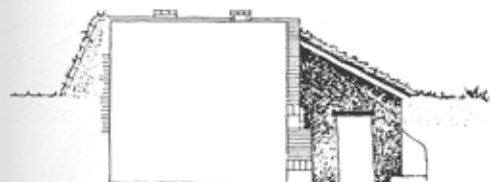
Tværsnit af ovnen. Når stenene var omhyggeligt stablet i ovnen, blev de delvis dækket med sand og jord for at undgå for hurtig brænding. De første dage fyrede man med tørv fra egen mose, op til 400° C, men derefter fyredes der med kul, som kunne bringe temperaturen op på 1000° C. Alt disponibelt mandskab skulle igang, når ovnen skulle tømmes for de ca. 36.000 sten og 4.000 drænrør, der var anbragt øverst, da de ikke tålte for stærk varme. Normalt nåede man at brænde 10 ovnfulde sten og drænrør i de 5 måneder, sæsonen varede. Futtrup-teglovnen har været 8 meter lang, 3 meter bred og ca. 3,5 meter dyb. Fra tilbygningen til højre på billedet fyredes der gennem 4 små døre ind til selve ovnen
